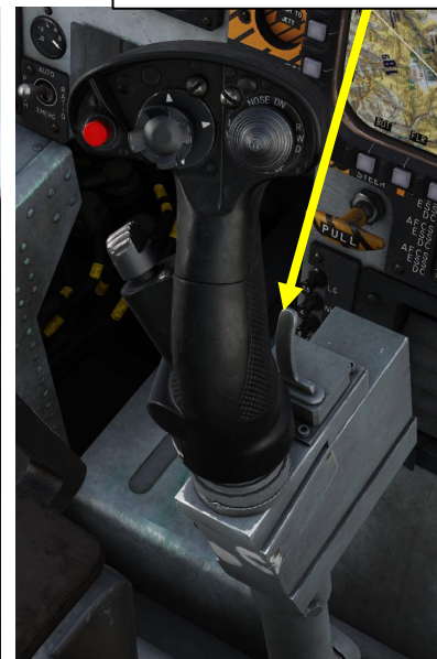
16 Paddle Switch • Disengages Autopilot
